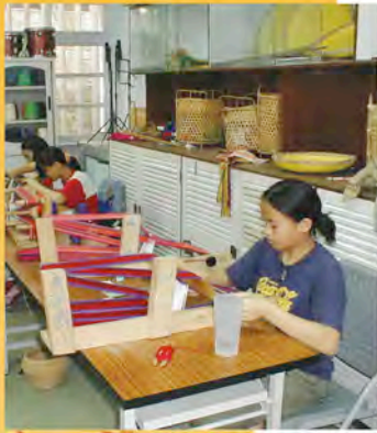
現代改良式織布機—桌上機，可織出頭帶、小桌巾、領帶等美麗的作品。
