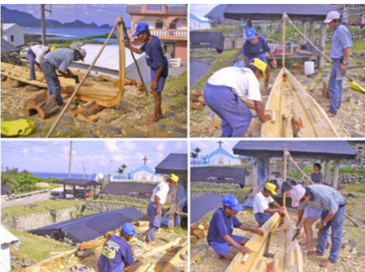
野銀S家挑選家族海崖林地內大徑木拼裝大船，著眼在不受潮，主幹粗直、質地硬、耐腐蝕、耐磨擦耗損，攝於2006年10月。
